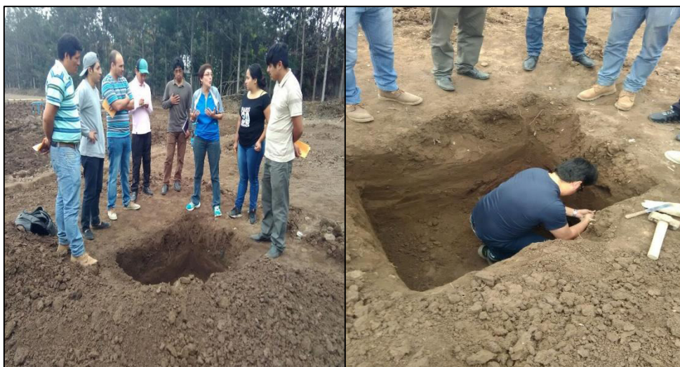
Anexo 1: Calicata para determinar las características fisicoquímicas del suelo.
