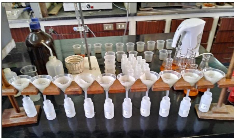
**Figura 5: Filtrado de los extractos de concentración de elementos**
