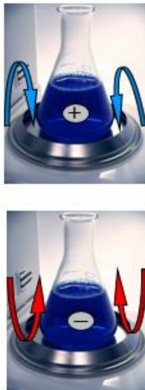
Figura 6: Efecto de la temperatura de la muestra en la pesada.
