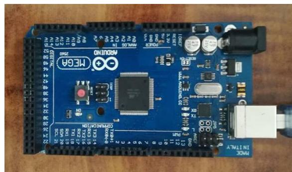
Figura 87: Arduino Mega 2560 utilizado en el proyecto
