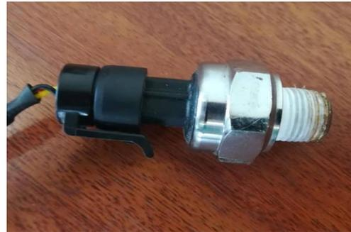
**Figura 89: Transductor de presión HK3022 utilizado en el proyecto**
