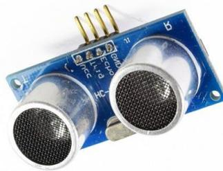
**Figura 5: Sensor de ultrasonido HC-SR04.**
