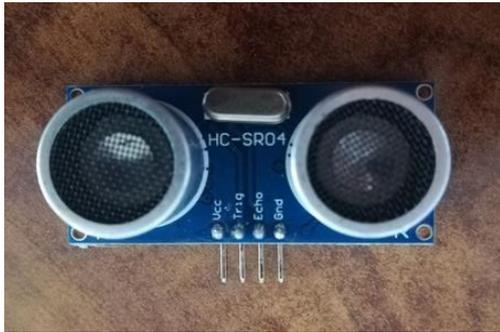
**Figura 88: Sensor de ultrasonido HC-SR04 utilizado en el proyecto**
