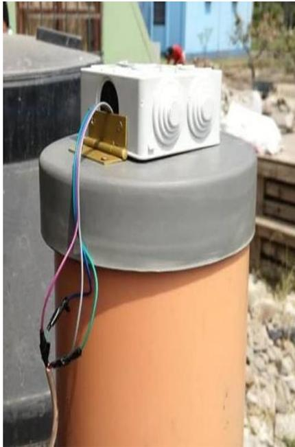
**Figura 80: Caja pase de 100x100mm que alberga al sensor de ultrasonido**
