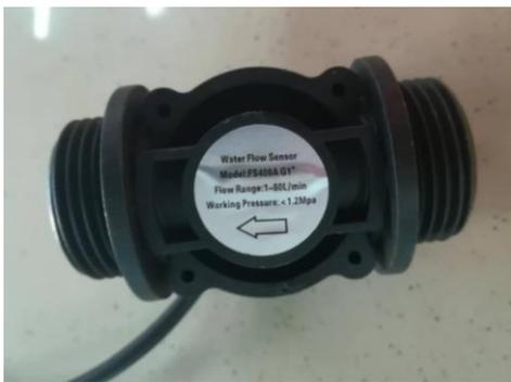
Figura 84: Sensor de caudal FS400 de 1" utilizado en el proyecto
