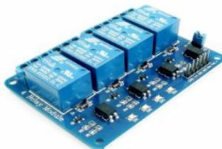
**Figura 6: Modulo Relé de 4 canales.**
