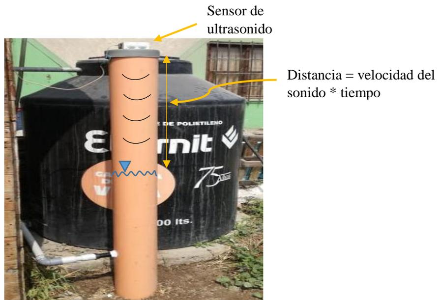
**Figura 31: Vaso comunicante para el sensor de ultrasonido.**
