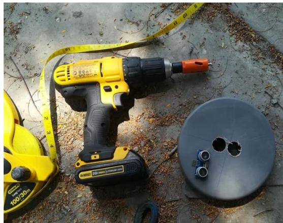
**Figura 61: Materiales para la instalación del sensor de ultrasonido**
