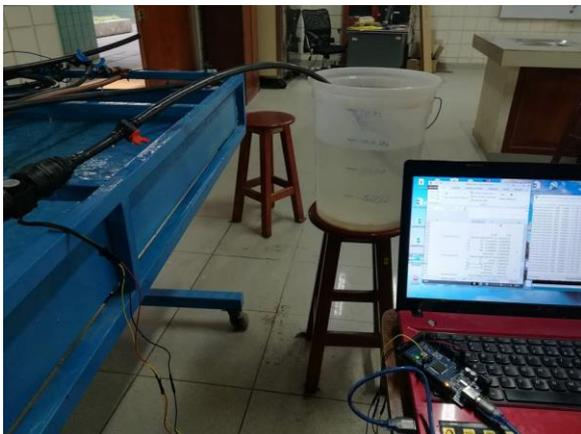
**Figura 60: Ensayo para el sensor de flujo de agua de 1"**
