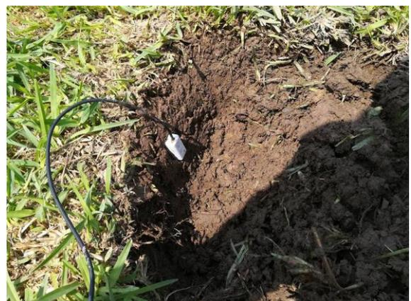
**Figura 73: Instalación del sensor de humedad GS1 a 10 cm de la superficie.**
