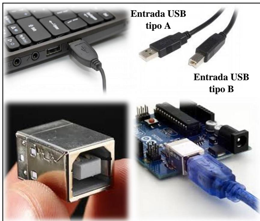
**Figura 1: Entrada USB PC-Arduino**
