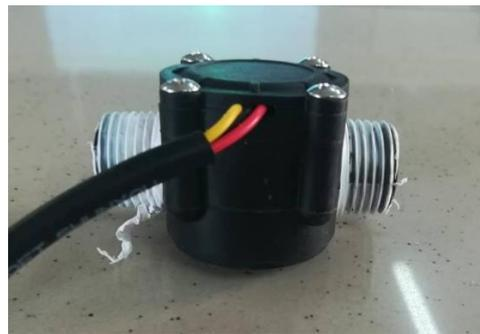
Figura 85: Sensor de caudal YF-S 201 de 1/2" utilizado en el proyecto
