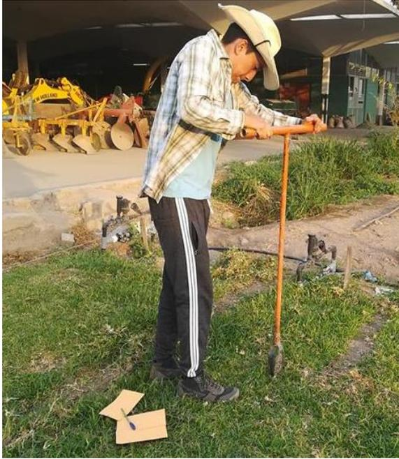
**Figura 75: Toma de muestra de suelo para la calibración del sensor de humedad.**
