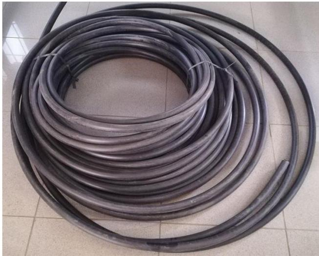
**Figura 65:** Manguera de polietileno de 32 mm utilizada para conducir los cables eléctricos.
