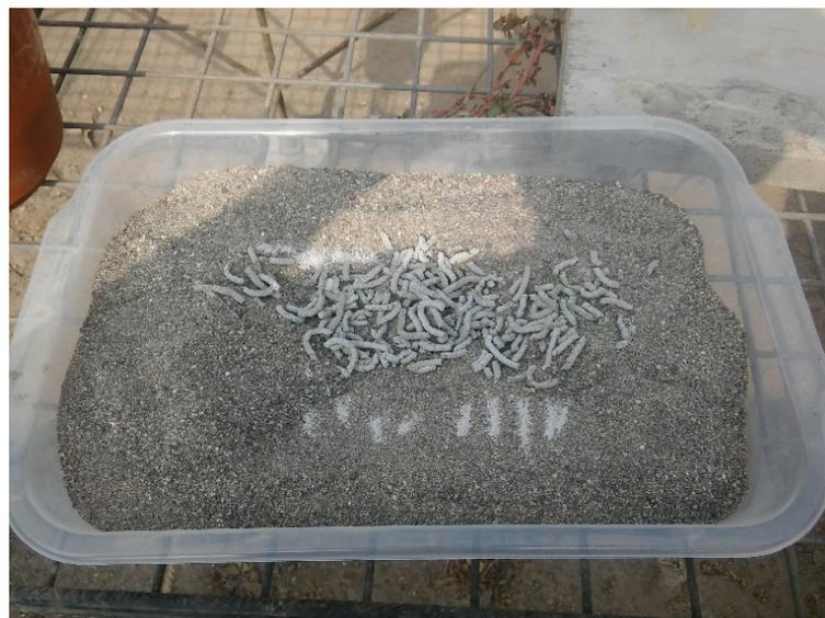
**Figura 13:** Pellets en arena de río para la prueba de campo
