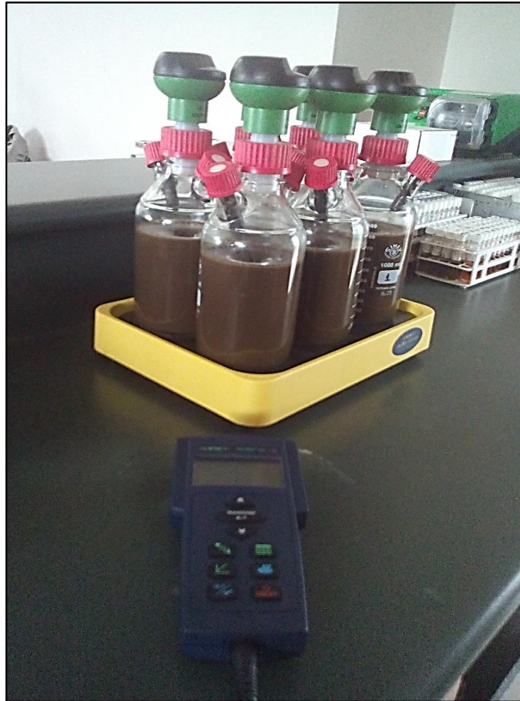
Figura 17: Monitoreo continuo en el Sistema OxiTop
