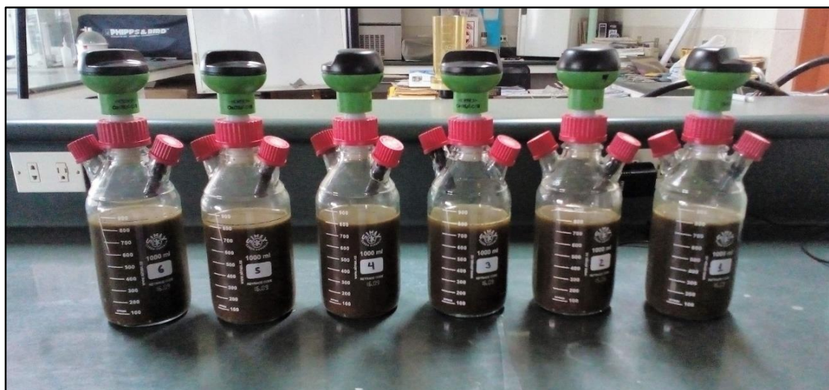
Figura 16: Preparación de las muestras en el Sistema OxiTop
