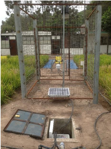
Sistema de sensores térmicos de termocuplas y colector de datos en campo
