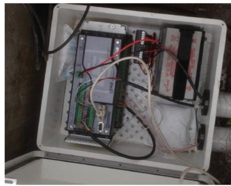
Colector de datos de los sensores térmicos de termocuplas
