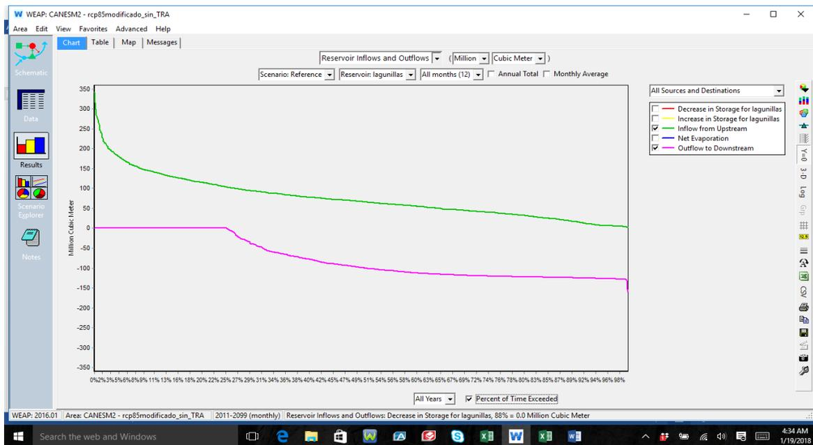
**Figura 119: Curvas de Duración de caudales ingreso y salidas en porcentaje, operando solo lagunillas y trasvasamiento de las aguas del Rio Verde a la Presa de Lagunillas y con las demandas planteadas (100%) con efecto de Cambio Climático CANES4.5**
