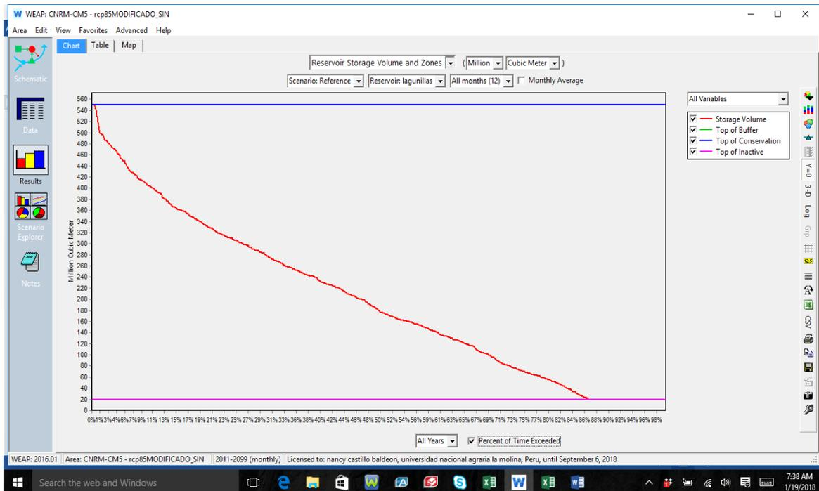
**Figura 142: Volúmenes Almacenados en lagunillas, Operando lagunillas, y reservorio verde y con las demandas planteadas (100%), con CNRM\_CMI8.5 LAGUNILLAS**
