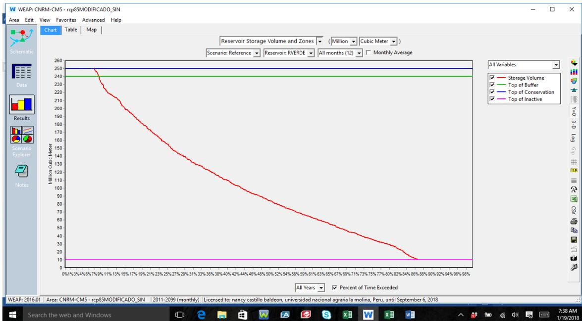
**Figura 143: Volúmenes Almacenados en lagunillas, Operando lagunillas, y reservorio verde y con las demandas planteadas (100%), con CNRM\_CMI8.5 RESERVORIO VERDE**
