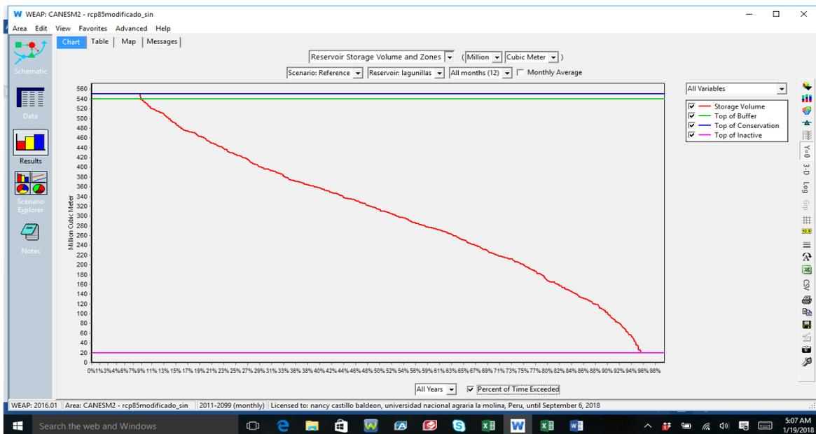
**Figura 136: Volúmenes Almacenados en lagunillas, Operando lagunillas, y reservorio verde y con las demandas planteadas (100%), con CANES4.5 LAGUNILLAS**
