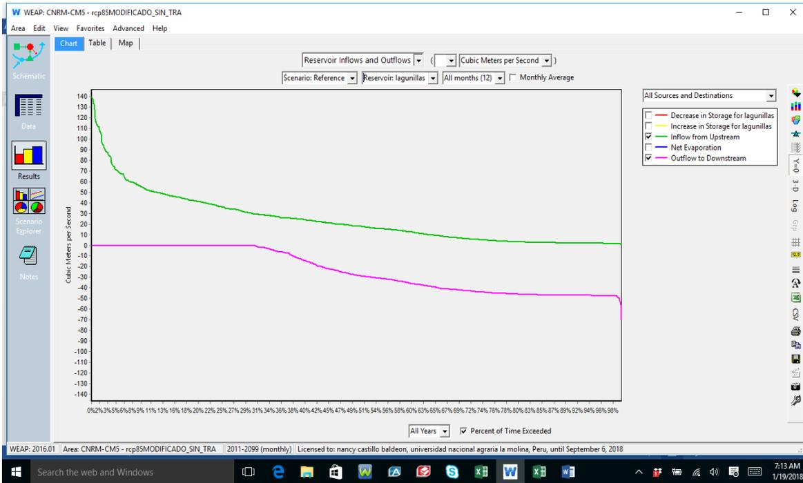
**Figura 122: Curvas de Duración de caudales ingreso y salidas en porcentaje, operando solo lagunillas y trasvasamiento de las aguas del Rio Verde a la Presa de Lagunillas y con las demandas planteadas (100%) con efecto de Cambio Climatico CNRM\_CMI8.5**
