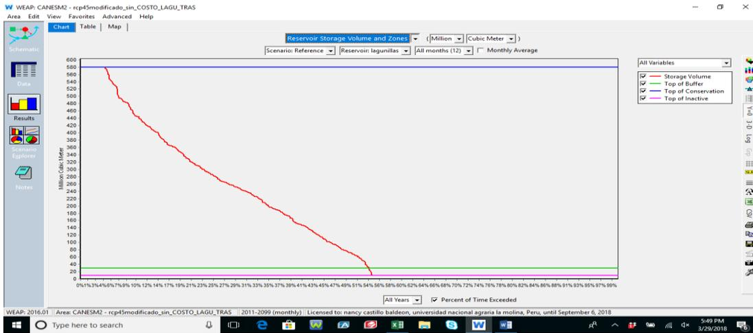
Figura 192: Volumen del reservorio lagunillas, escenario de cambio climático CNRM\_CM5-RCP4.5
