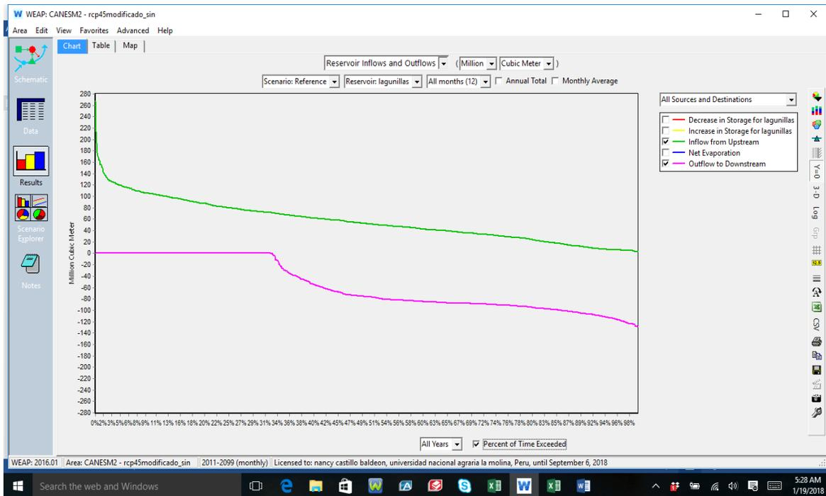
**Figura 147: Porcentajes de caudales ingresados y egresados en lagunillas, operando lagunillas, y reservorio verde y con las demandas planteadas (100%), con CANES8.5 LAGUNILLAS**
