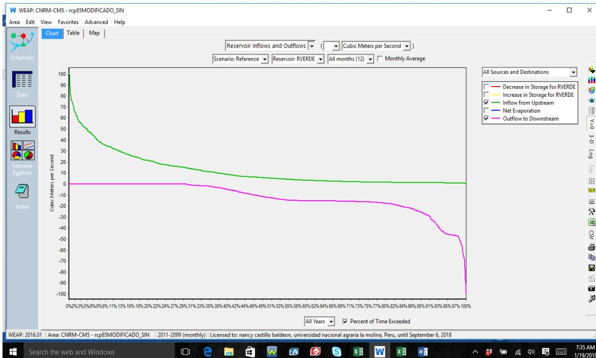
**Figura 152: Porcentajes de caudales ingresados y egresados en lagunillas, operando lagunillas, y reservorio verde y con las demandas planteadas (100%), con CNRM\_CMI8.5 RESERVORIO VERDE**
