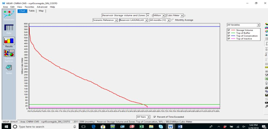
Figura 210: Volumen del reservorio lagunillas, escenario de cambio climático CNRM\_CM5-RCP4.5
