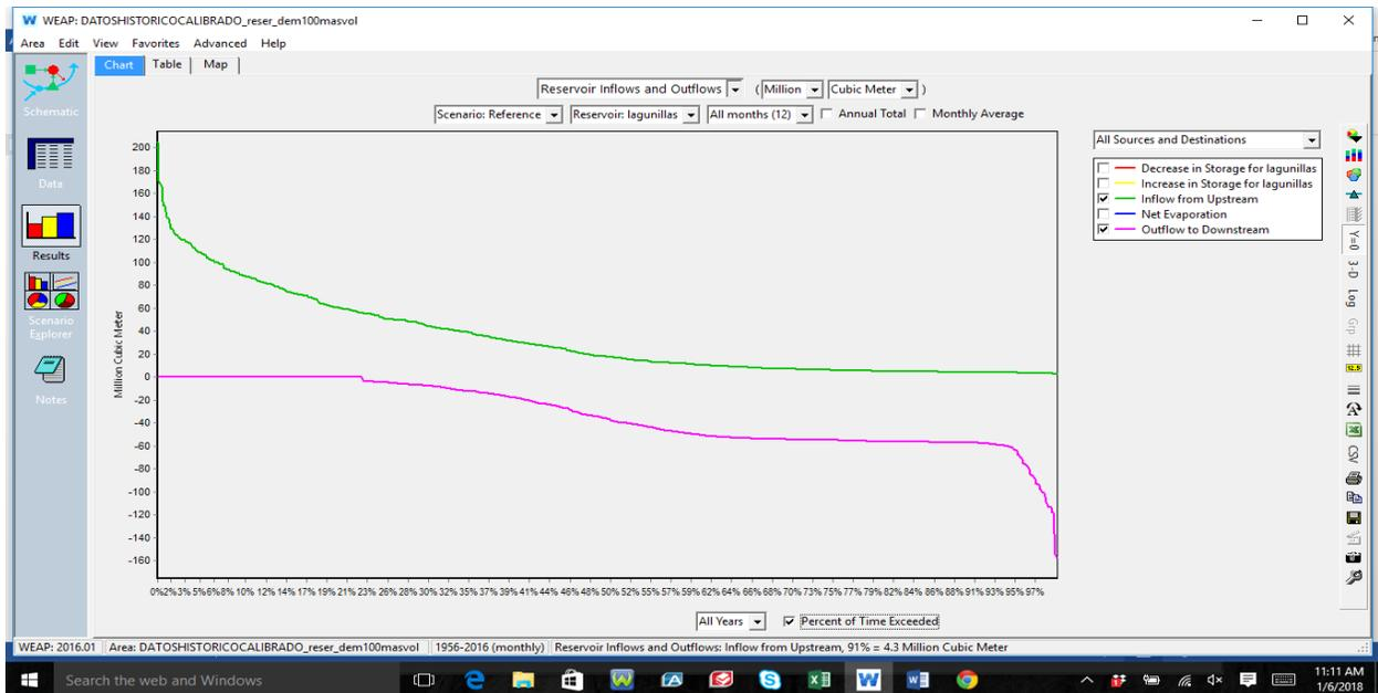
**Figura 77: Porcentajes de caudales ingresados y egresados en lagunillas, Operando lagunillas, y reservorio verde y con las demandas planteadas (100%)**
