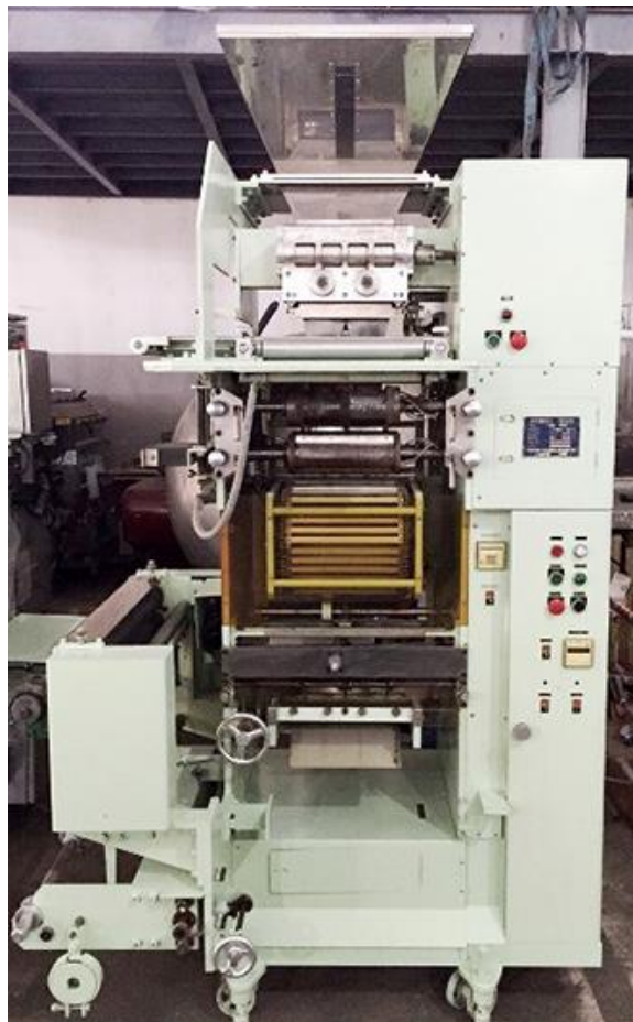
d. Empacadora de polvos Yokohama
