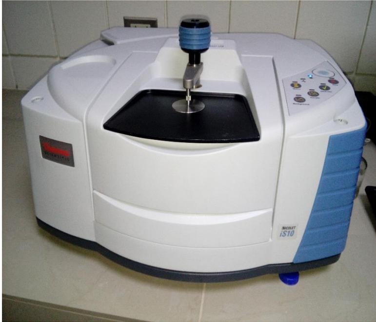
**Figura 34: Espectroscopio infrarrojo con Transformada de Fourier (FTIR)**
