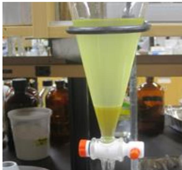
Figura 33: Separación del biodiesel de la glicerina procesada con ultrasonido
