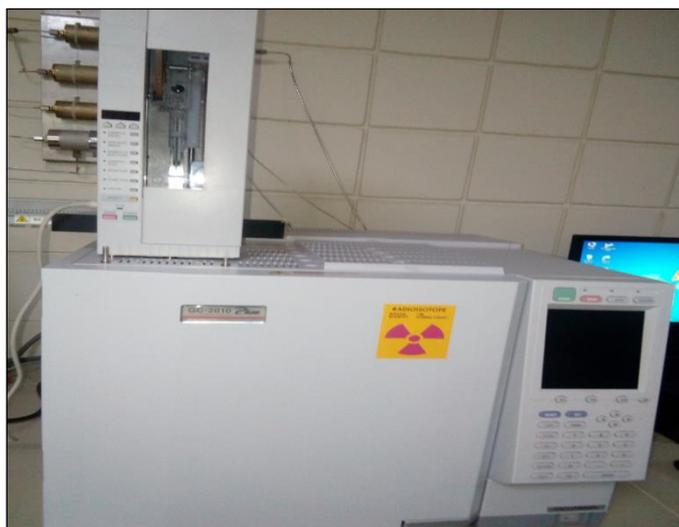
**Figura 29: Cromatógrafo de gases para determinación de metilésteres de aceite de canola**
