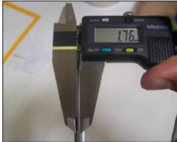
Figura 16: Pie de rey o vernier empleado para la medición de la altura de rizo de cabezales easy-open .
