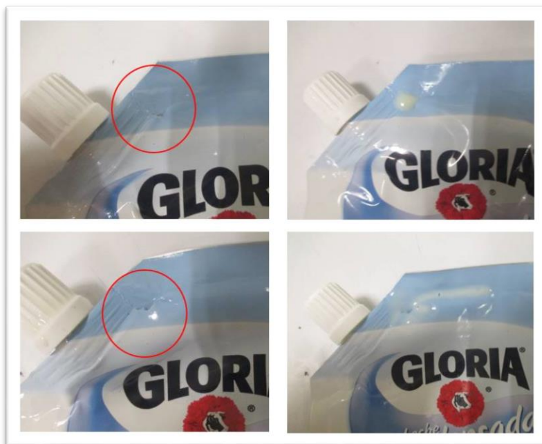
Figura 6: Defectos de hermeticidad en envases Doypack .
