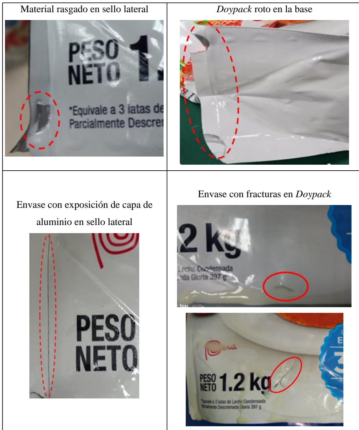
Figura 9: Detalle de defectos encontrados en envases Doypack luego de prueba de transporte.
