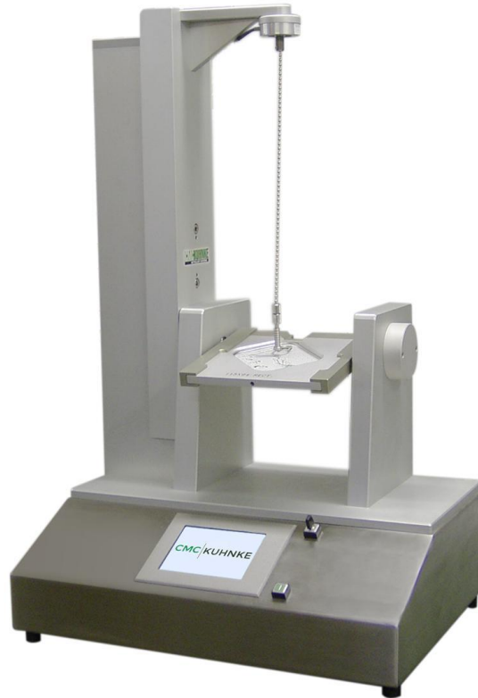
Figura 30: Pop & Tear tester empleado para las evaluaciones de apertura de los cabezales.
