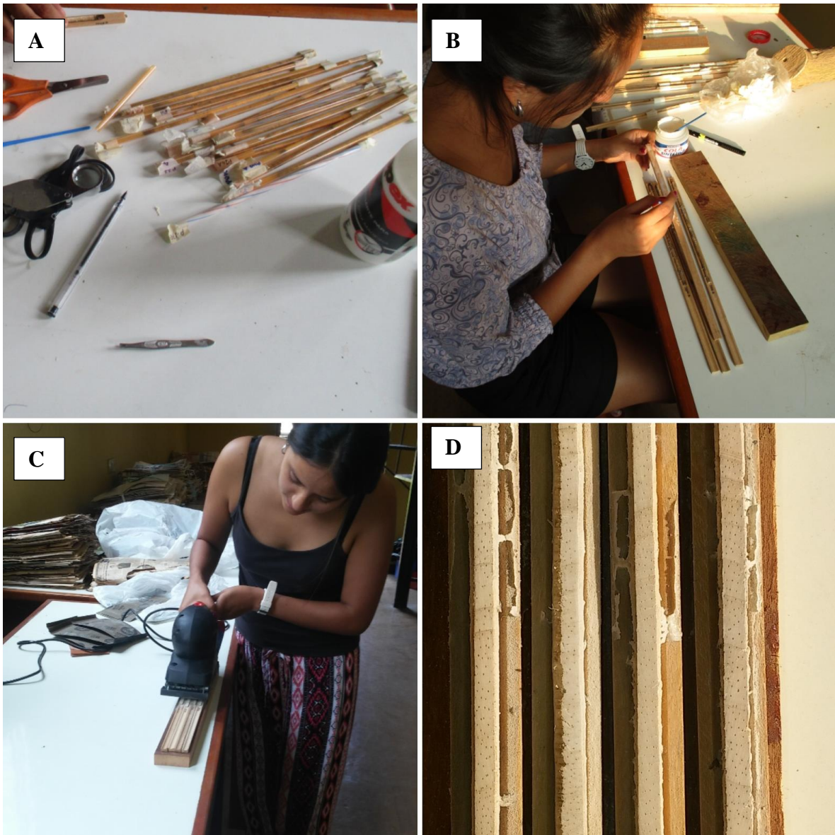
(A) Materiales a usar (B) Pegado de las muestras sobre los soportes y luego sobre la tabla de madera (C) Lijado de muestras (D) Muestras para ser analizadas
