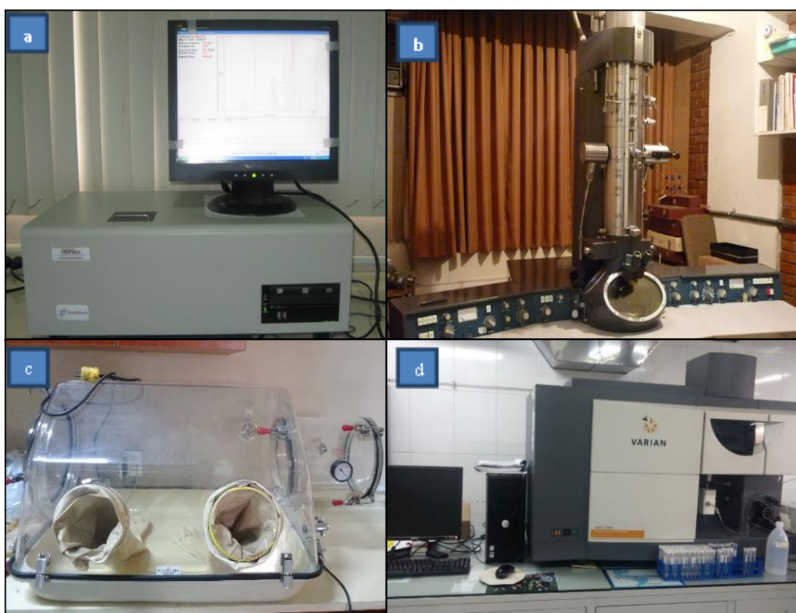
Figura 9: Equipos utilizados en la síntesis, caracterización y adsorción de metales a) DLS-Brookhaven 90 plus b) Microscopio electrónico de transmisión (TEM)-Philips 300, c) Glove Box-Plus Labs, c) ICP-OES Varian 735-ES
