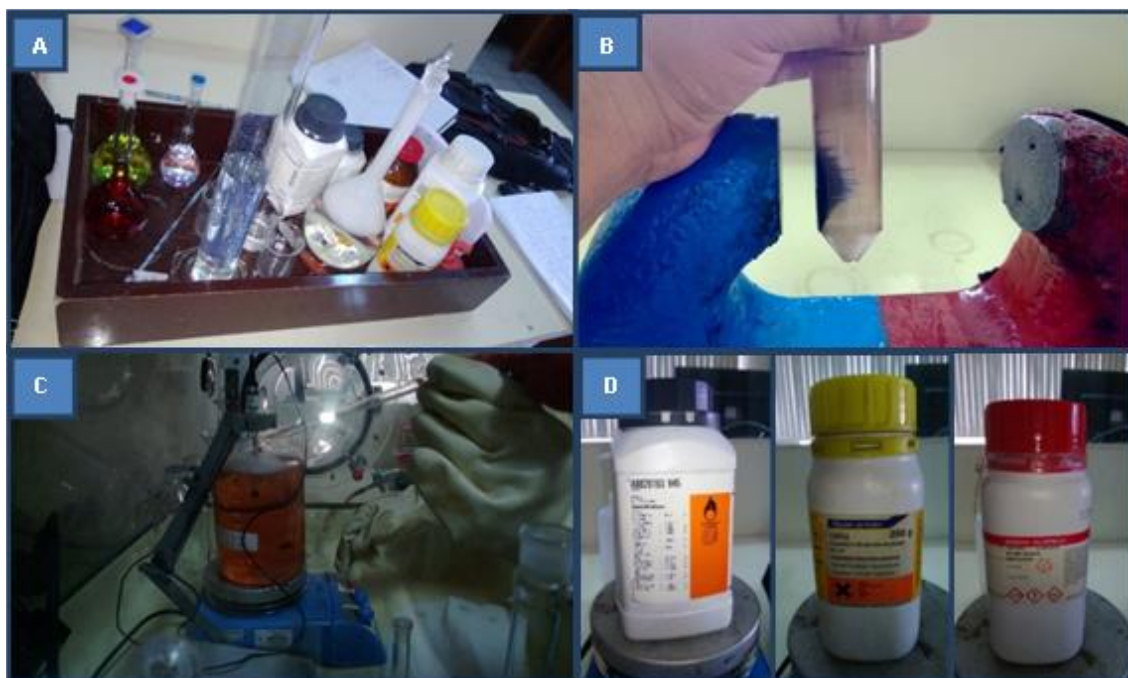
Figura 10: A) Soluciones utilizadas en la preparación de las NPs, B) NPs en interacción con un campo magnético, C) Preparación de las NPs en atmósfera inerte (Glovebox), D) Reactivos utilizados en la preparación de las NPs
