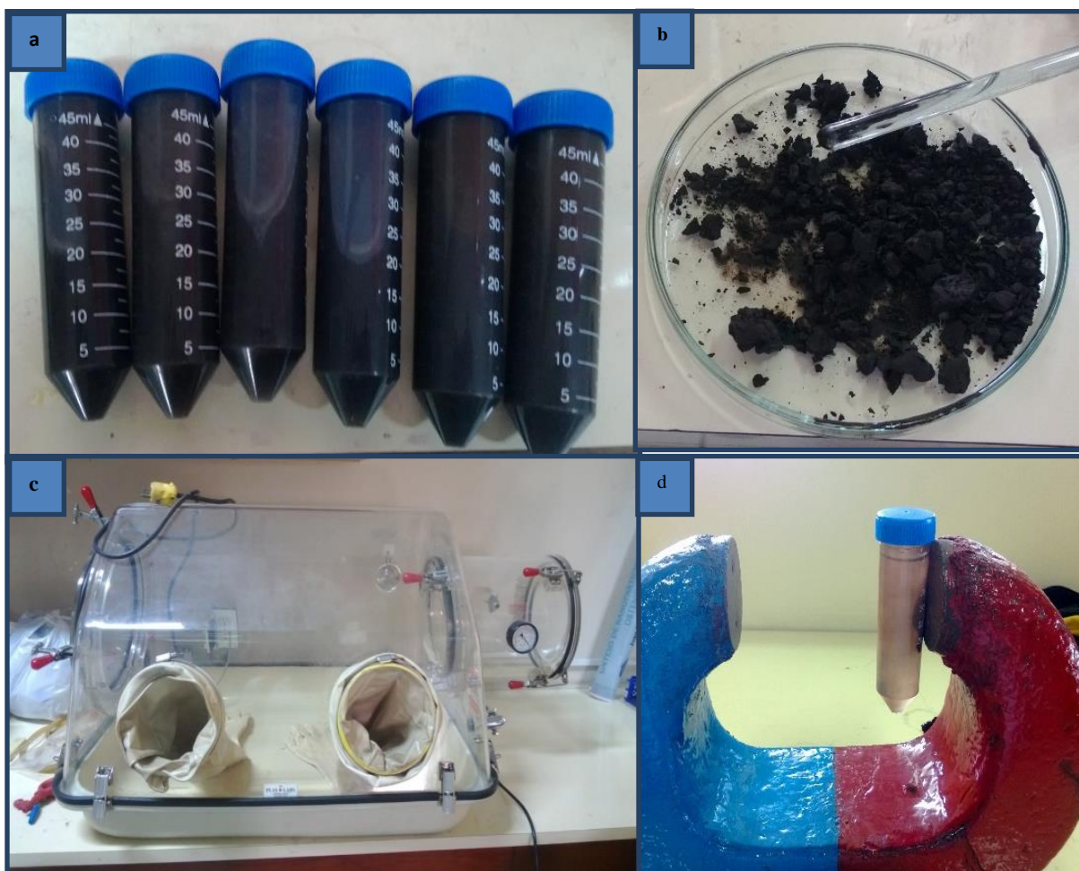
Figura 26: a) Soluciones de NPs estabilizadas con CTAB, b) NPs secas, c) Equipo glovebox utilizado en la síntesis de las NPs, d) Solución de NPs en la cual se aprecia el grado de magnetismo
