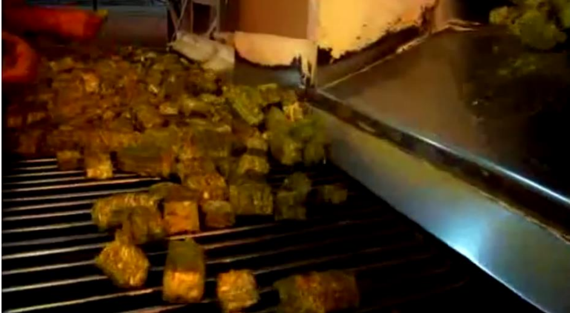
Figura 6. Inyección de aire caliente a los cubos de alfalfa
