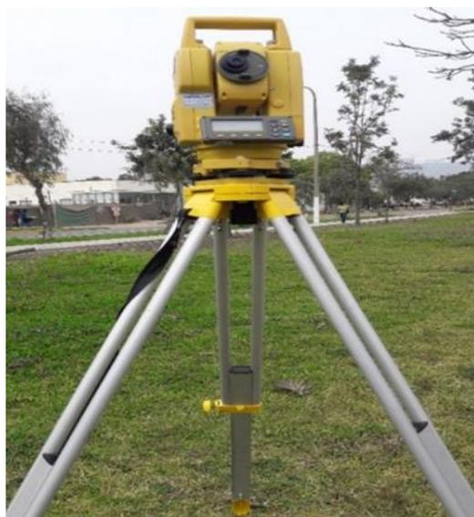
**Figura N° 13: Estación Total TOPCON GTS 102N**
