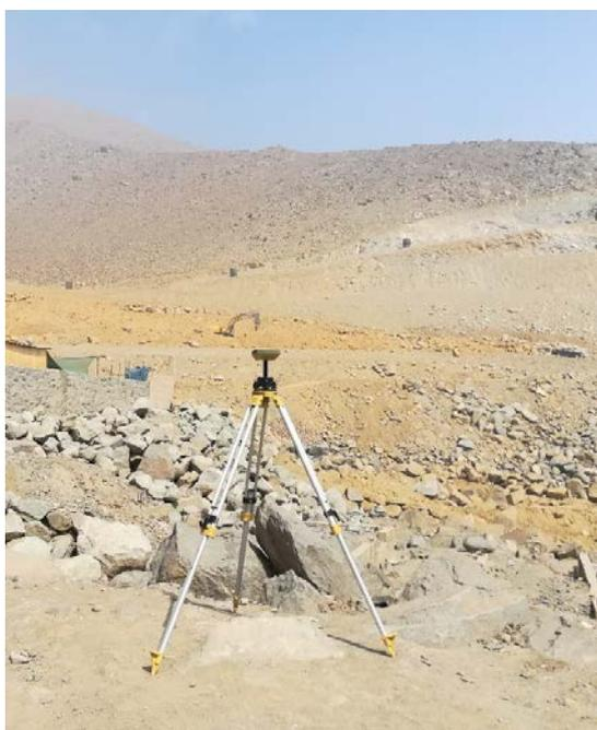
**Figura 10 Toma de puntos de control con el receptor GNSS**
