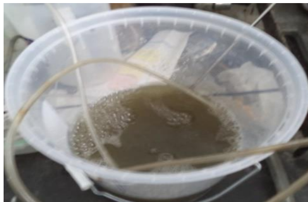
Figura 7: Aireación del efluente
