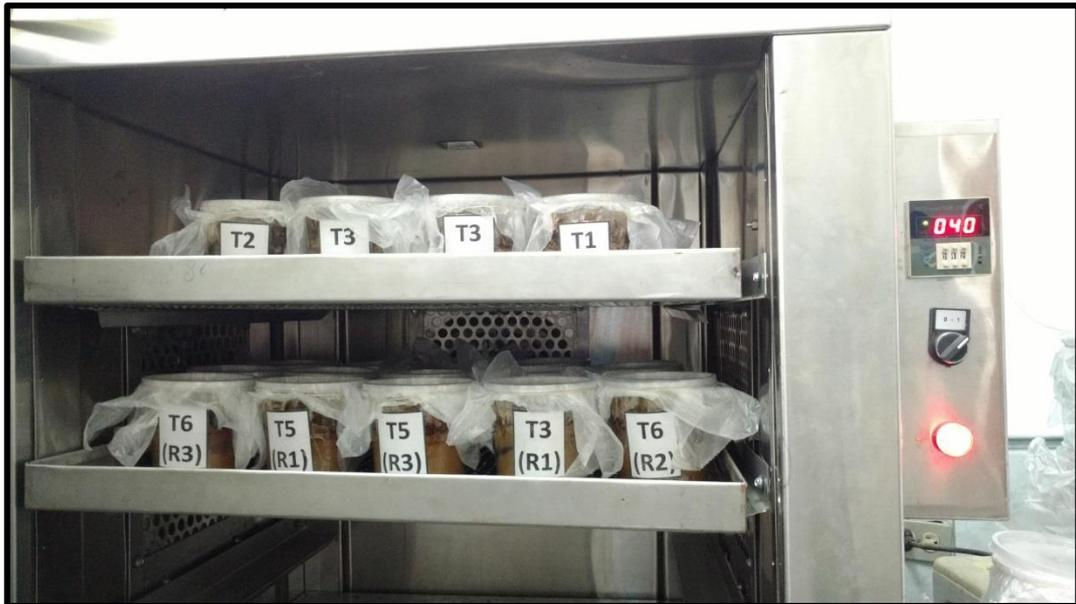
**Fotografía 3: Fermentación anaeróbica a 40°C por 5 días (Escala laboratorio)**
