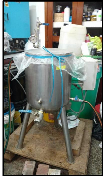
Fotografía 5: Fermentación anaeróbica a 40°C por 5 días (Escala piloto)
