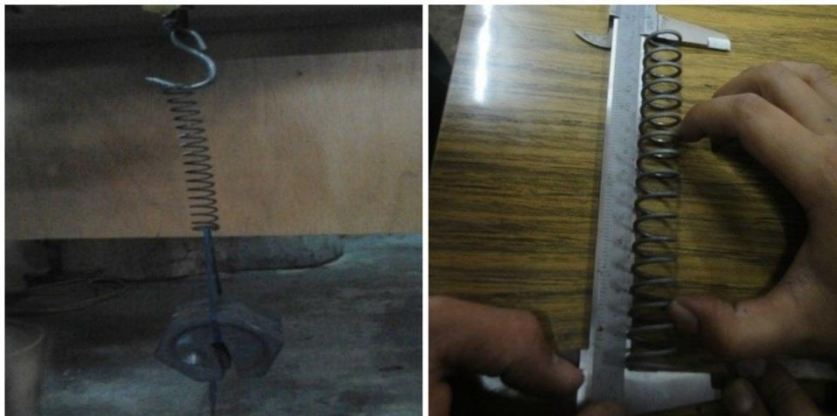
Figura 12: Calibración del resorte.
