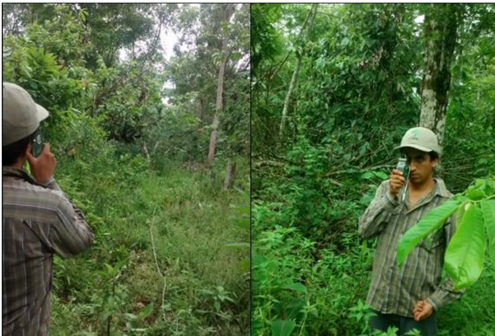
Figura 6: Medición de variables con el relascope de Bitterlich
