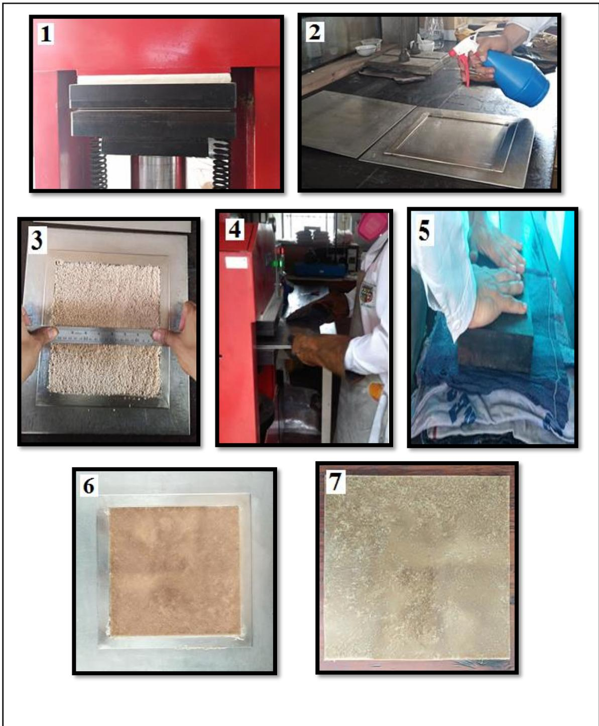
(1) calentamiento de las placas y marco metálico; (2) aplicación de silicona en superficies de placas; (3) homogeneización de la mezcla extruida; (4) ingreso de placas a prensa; (5) enfriamiento de placas; (6) desmoldado de placas y marco metálico; (7) material compuesto.
