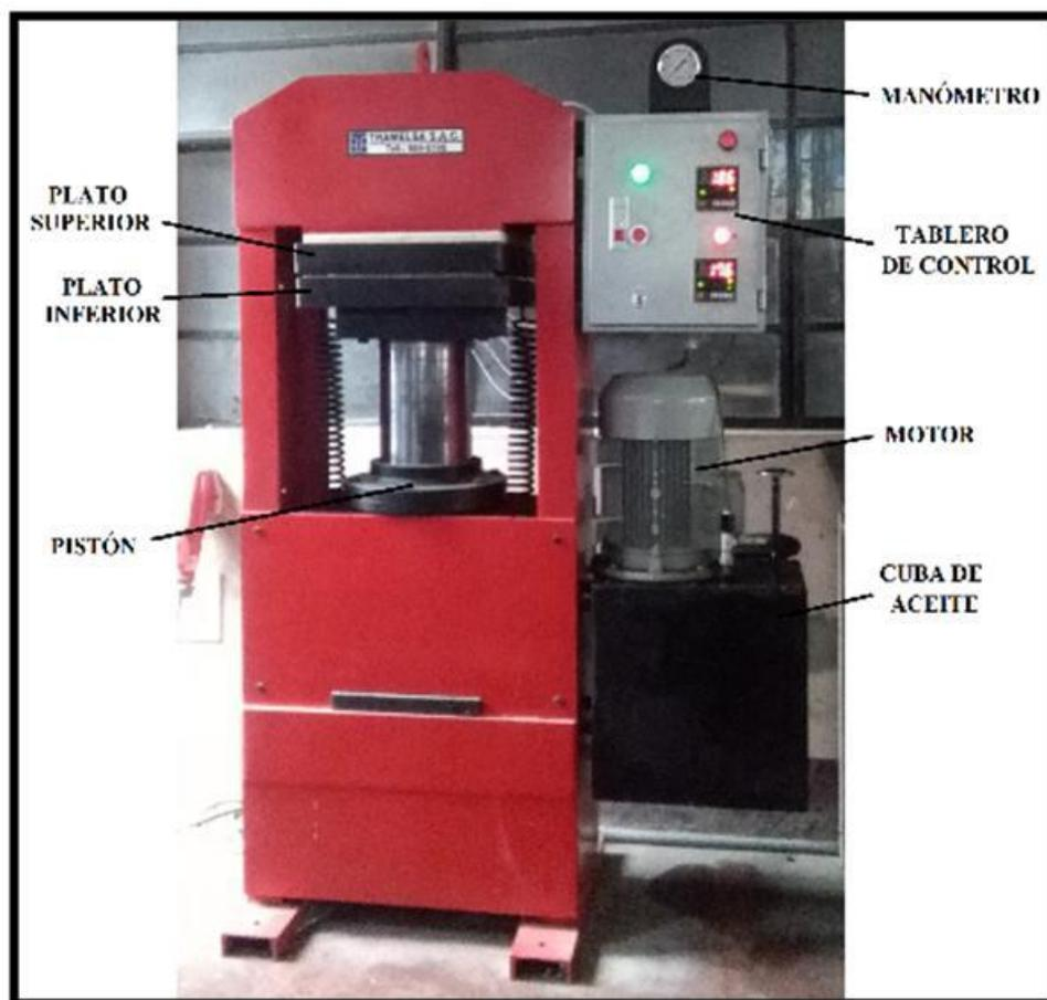
Figura 12: Prensa hidráulica de vulcanizado de caucho 60 TN, Laboratorio de Transformación Química de la Madera – Universidad Nacional Agraria La Molina.
