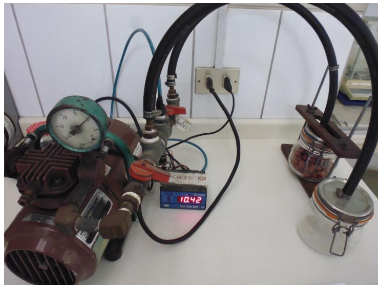
Figura 15: Porosímetro de Day, modificado por Ureña.
