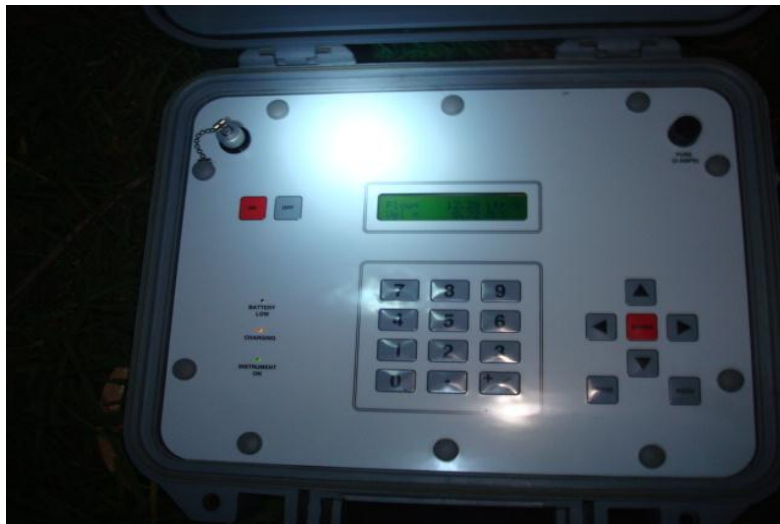
Figura 38: Medición de caudal con caudalímetro portátil en la estación 2
