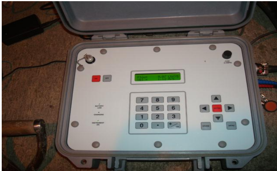
Figura 35: Medición de caudal con caudalímetro portátil en la estación 1
