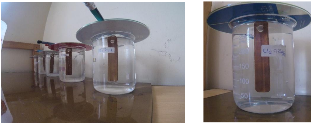
Figura 9: (a) Cupones sumergidos en soluciones de 0,25; 0,5; 0,75; 1,0; 2,0; 5,0 mg/L de cloro; (b) cupón sumergido en 250 mL de solución
