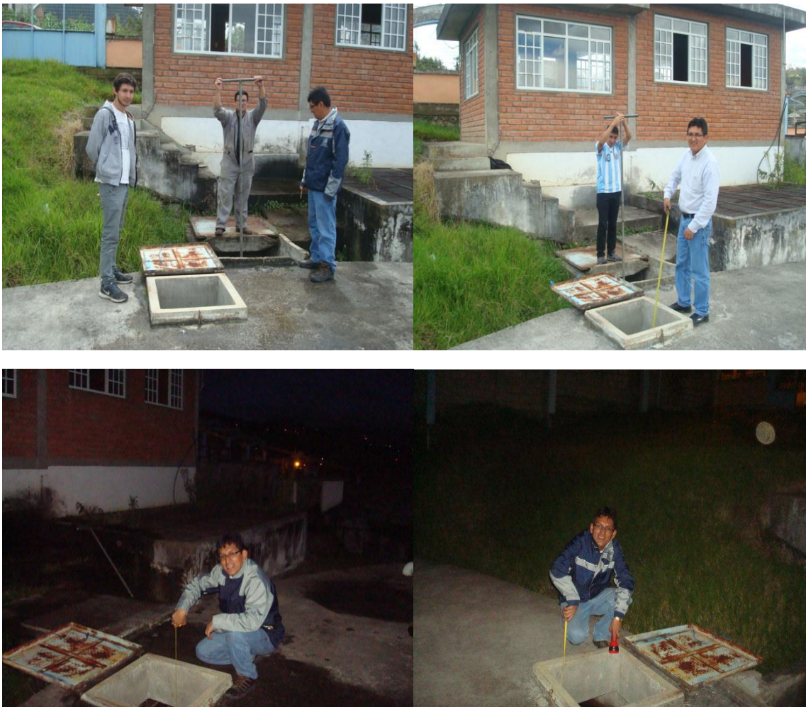
Figura 12: Medición de la demanda horaria en el tanque de abastecimiento. Cerrando la válvula de ingreso (fotografía superior) previo a la medición de alturas. Medición de alturas durante la noche (fotografía inferior)
