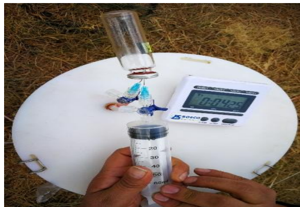
Figura 13: Recirculación del aire
