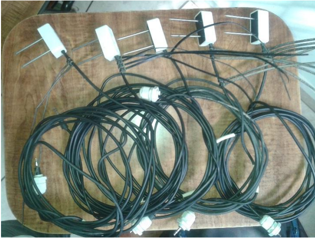
a) Sensores de humedad GS1 del FDR GS1.
