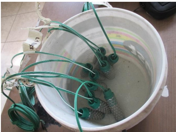
e) Saturación de watermark por 24 horas, antes de instalación en campo
