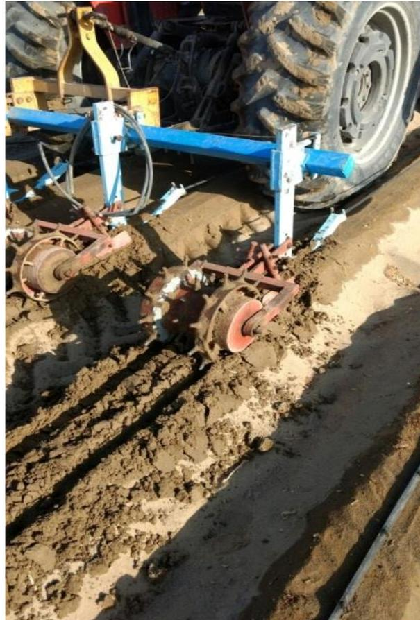
**Figura N° 11: Marcado y enterrado de cinta para trasplante**
