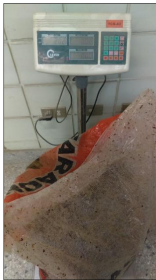
Figura 11: Pesado de las fibras de madera después de la mineralización.
