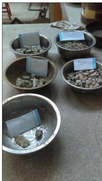
Figura 9: Granulometría del agregado grueso.
