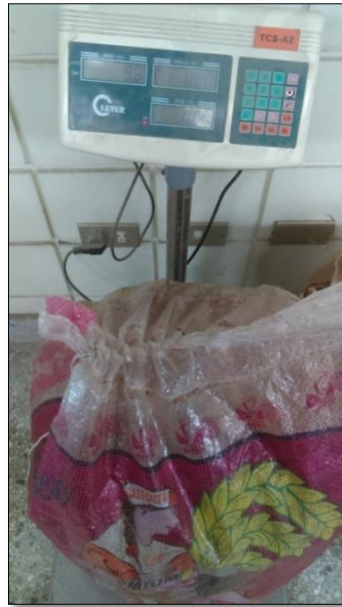
Figura 10: Pesado de las fibras de madera antes de la mineralización.
