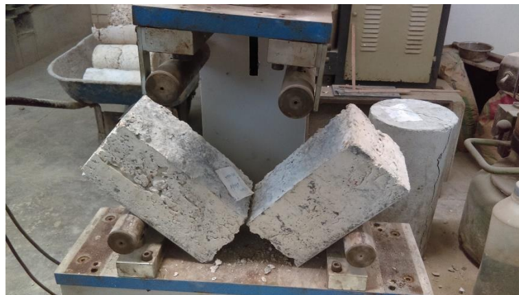
Anexo N° 22: Falla de la muestra del concreto tipo P1+F1.
