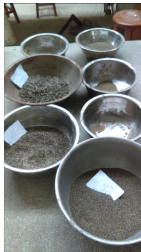
Figura 8: Granulometría del agregado fino.
