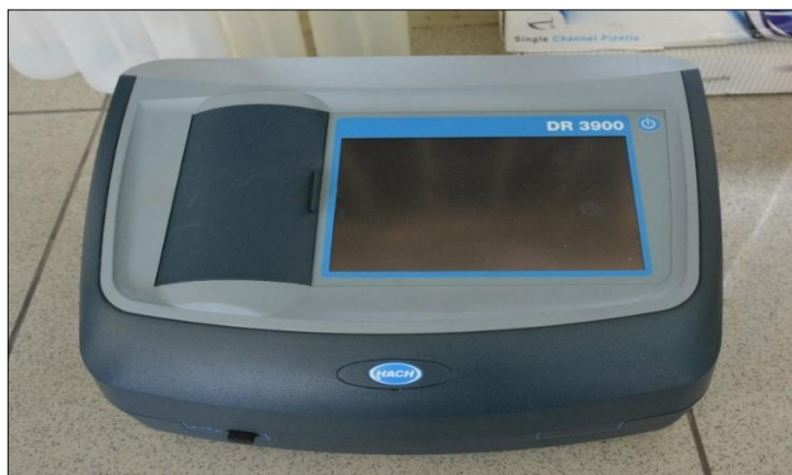
Anexo 10: Espectrofotómetro marca HACH modelo DR3900 , usado para medir compuestos nitrogenados.
