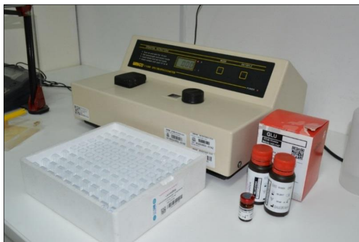
Anexo 9: Espectrofotómetro marca UNICO modelo 1100 , usado para determinar la concentración de glucosa.
