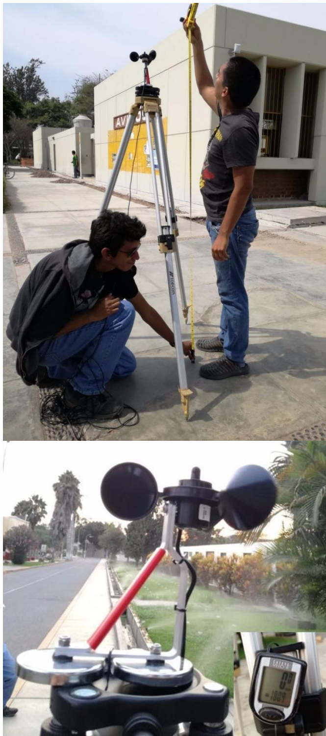
Figura 62: Instalación del anemómetro en campo
