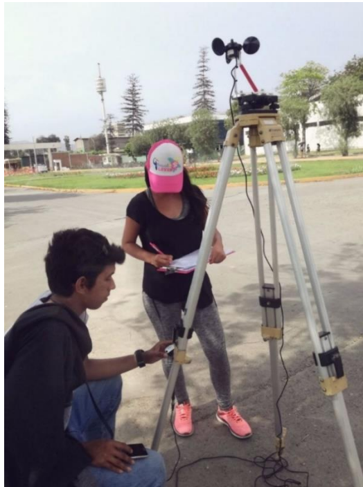
Figura 65: Toma de datos de la velocidad de viento en campo
