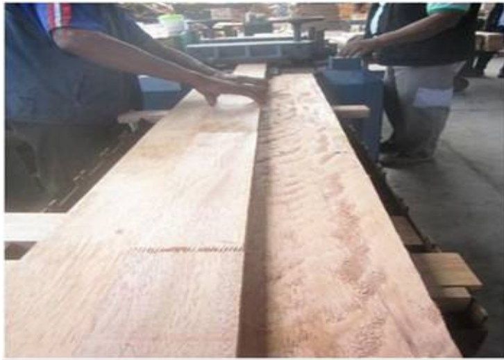
Figura 8: Laminas saliendo de la juntadora
