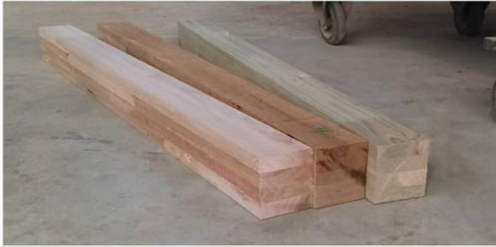
Figura 16: Vigas de eucalipto, tornillo y pino
