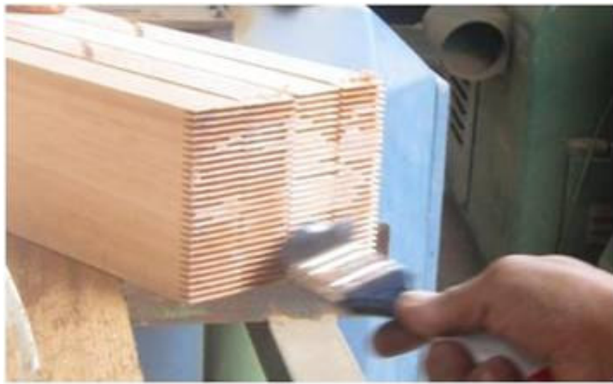
Figura 6: Encolado de Dientes con brocha
