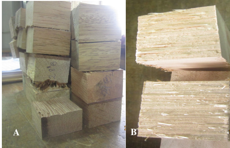
(A) Probetas despues del ensayo y (B) Falla en probeta de pino.
