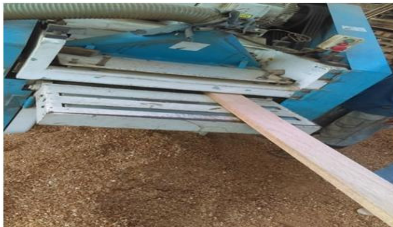
Figura 10: Cepillado de láminas
