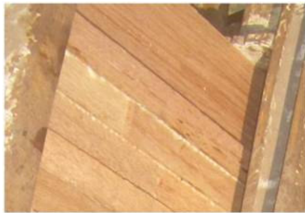
Figura 13: Escurrimiento del exceso de la cola, indicador de un buen encolado
