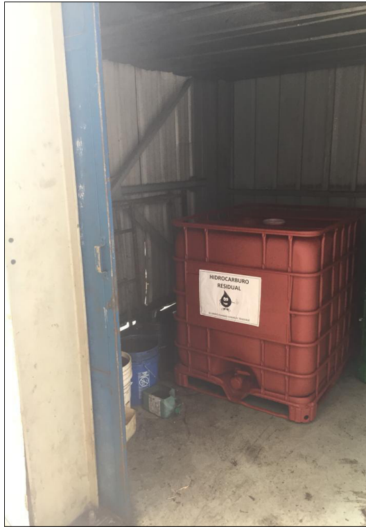
Contenedor para acopio de hidrocarburos residuales de acuerdo al código de colores
