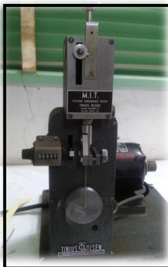
Figura 22: Aparato tipo MIT para determinación de resistencia al plegado.
