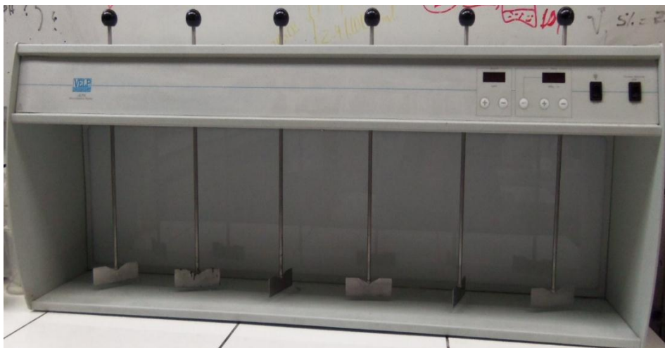
Figura 4: Equipo de pruebas de jarras.
