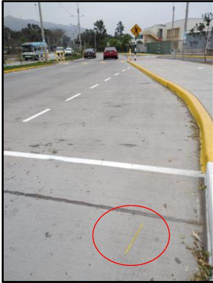
**Figura N° 35:** Registro de temperatura en pavimentos de losas de concreto (Sub-zona A) a las 12:30 pm. Día nublado.
