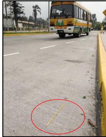
**Figura N° 36:** Registro de temperatura en pavimentos de losas de concreto (Sub-zona A) a las 4:30 pm, al exterior del campus.
