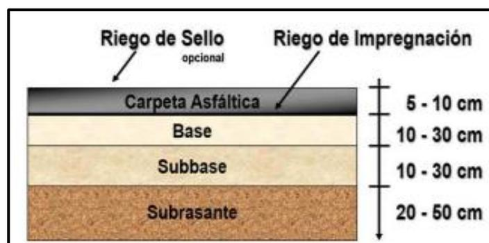
**Figura N° 01: Capas que conforman las estructuras de Pavimentos Flexibles.**
