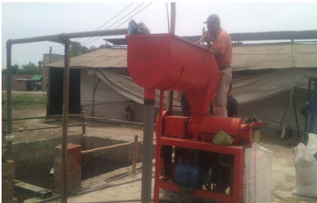
Figura 7. Producción de estiércol sólido - Máquina prensadora.
