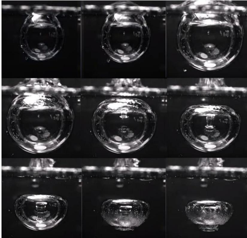
Figura 28 : Crecimiento y colapso de una burbuja de cavitación
