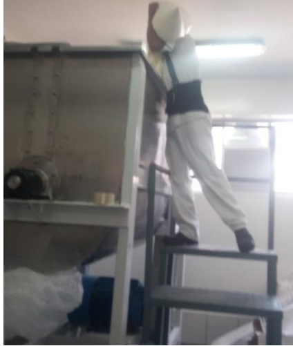
Figura 10: Operario depositando la materia prima utilizada para la obtención del puré de papa en polvo en la mezcladora de cintas.
