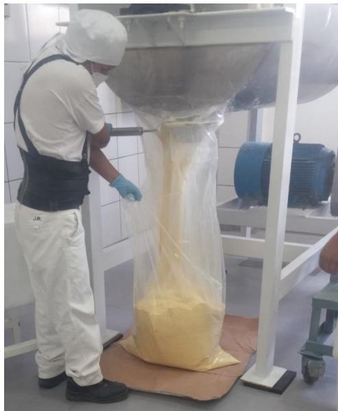
Figura 11: Proceso de descarga del puré de papa obtenido luego de 20 minutos de mezclado.
