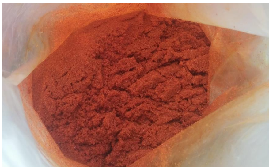
Figura 9: Sal coloreada, la sal industrial es pre mezclada con el Biocon® Atos 6WS.
