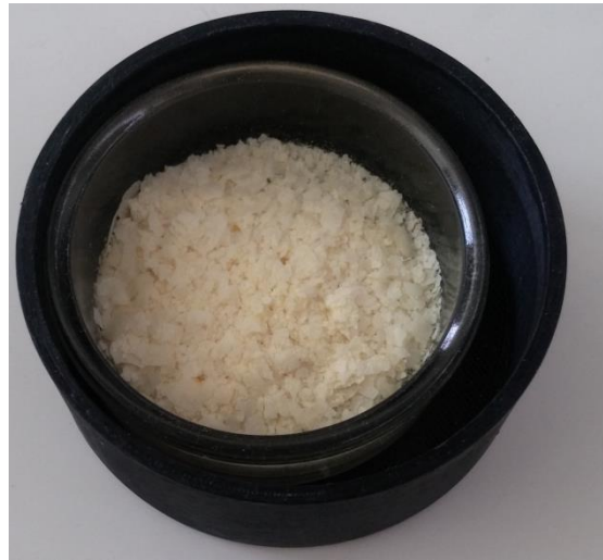
Figura 13: Cantidad de muestra (1.5 gramos aproximadamente) utilizada en el colorímetro Minolta®.
