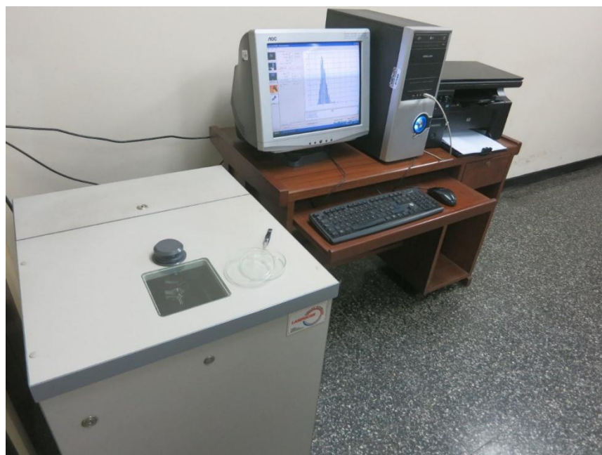
Figura 3: Equipo Sirolan LaserScan utilizado para el análisis de fibra.
