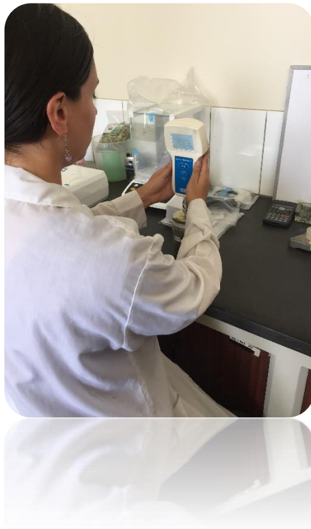
Foto 6: Medición de O 2 /CO 2 con el analizador de gases Oxybaby ® 6.0.
