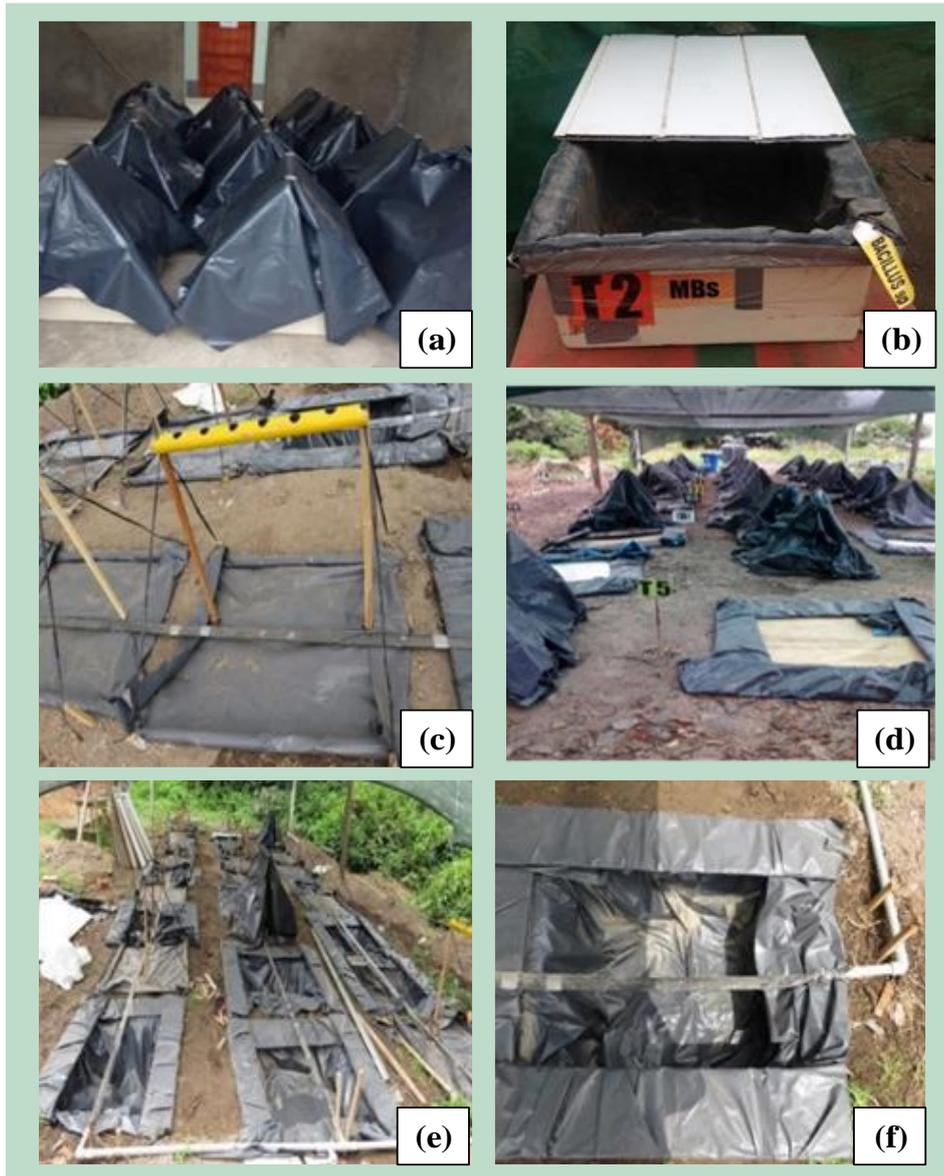
**Figura 15. Estructuras a nivel de laboratorio: (a) sistema techo a dos aguas (b) sistema en zanja. Estructuras a escala piloto (c y d) sistema techo a dos aguas; de 1m x 1m x 45 cm sobre la superficie cubierta con plástico (e y f) Sistema tradicional en zanja de 1 m x 1 m x 35 cm de profundidad cubierta con plástico**
