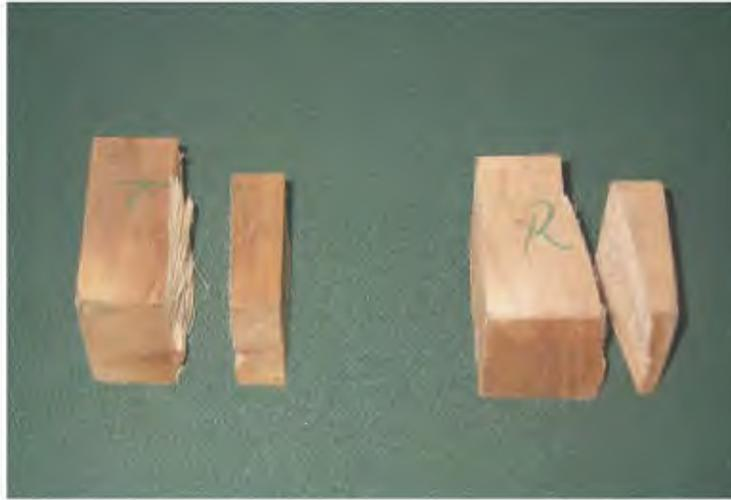
**Figura 10** Falla en Cizallamiento
