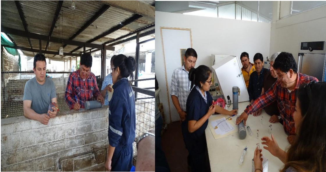
Figura 11: al a derecha retiro del cánister y lectura de la presión final, al cabo de 24 horas de colección y ala izquierda submuestreo de gases en viales de 20ml
