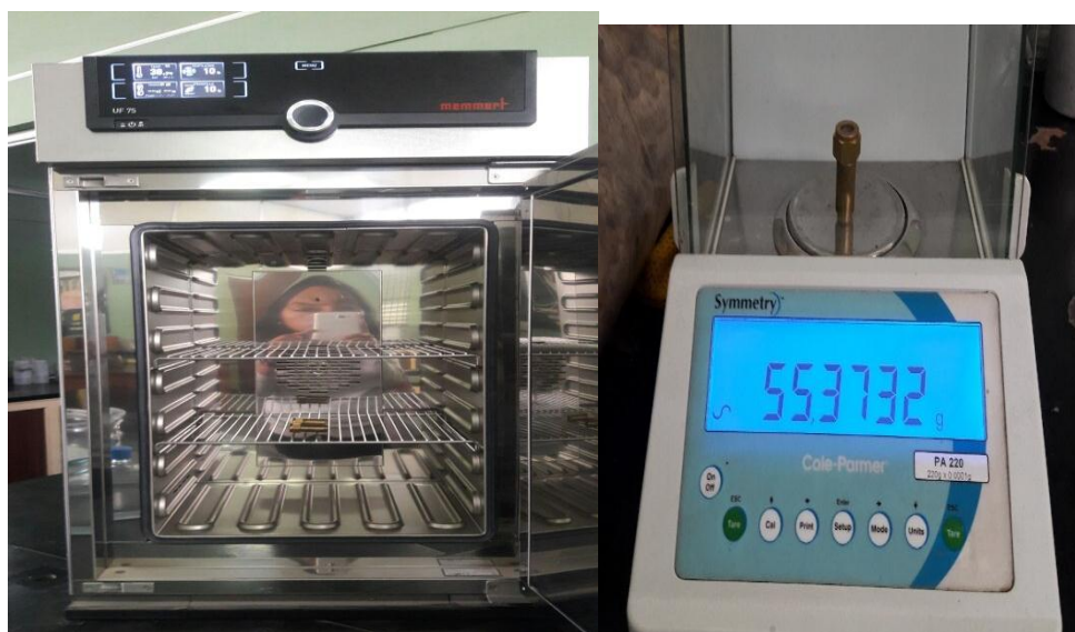
Figura 6: A la derecha estufa de aire forzado a 39 °C y a la izquierda el peso de las capsulas de permeación
