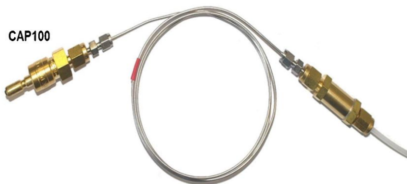
Figura 8: CAP100; Vástago de conexión rápida, unión reductora, tubo capilar de 100 cm, unión reductora, filtro de partículas de 15 µm, tubo de muestreo
