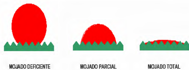
Figura 9 : EJEMPLOS DE HUMECTABILIDAD SUPERFICIAL
