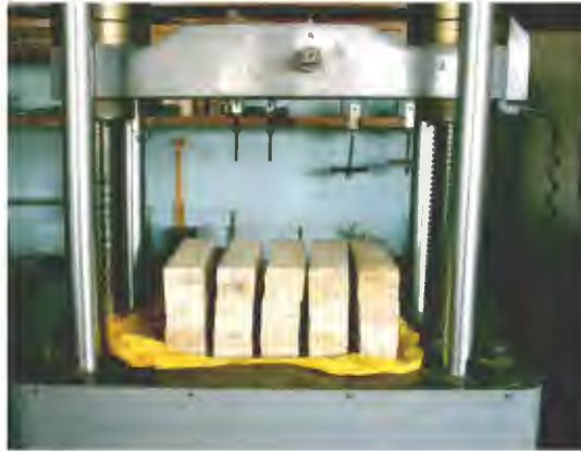
Foto 4: PRENSADO DE LOS LISTONES ENCOLADOS
