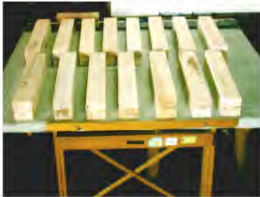
Foto 5 : ACONDICIONAMIENTO DE LOS LISTONES ENCOLADOS
