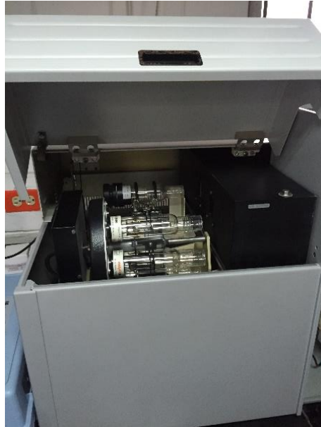
Figura 22: Fuente de emisión de líneas atómicas de plomo.
