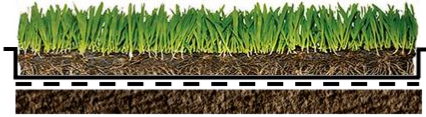
Figura 2: Recubrimiento de suelo con manta de polietileno 80x6+ malla raschel.
