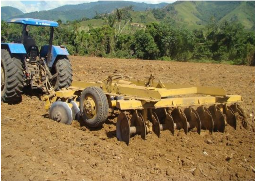
Figura 6: Grada de dos cuerpos con veinte discos
