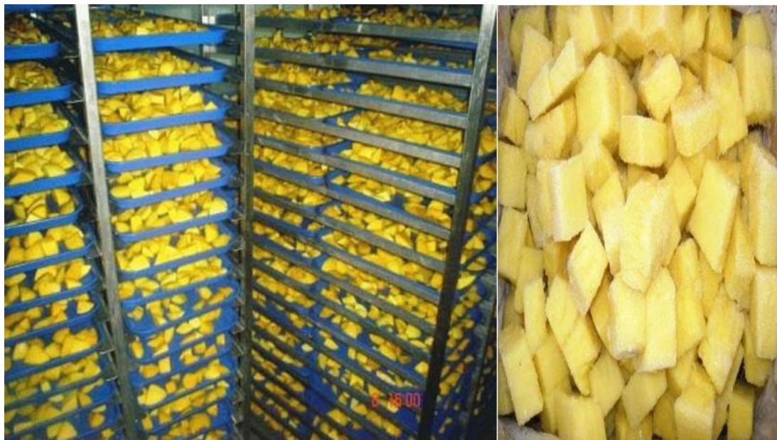
Figura 26: Cubos de piña, colocada en andamios, para su ingreso al proceso de IQF
