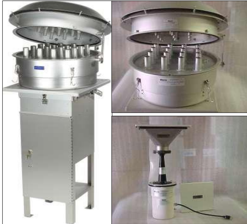
Figura 5: Equipo muestreador de partículas de alto volumen (Hi-vol)
