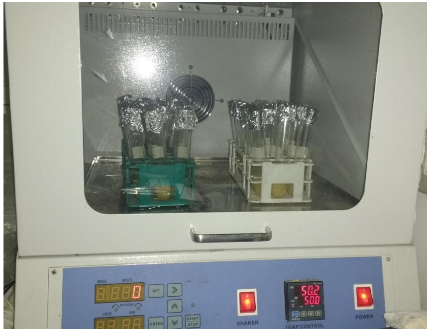
Fotografía 5. Incubación de la etapa hidrólisis enzimática, 50°C por 72 horas
