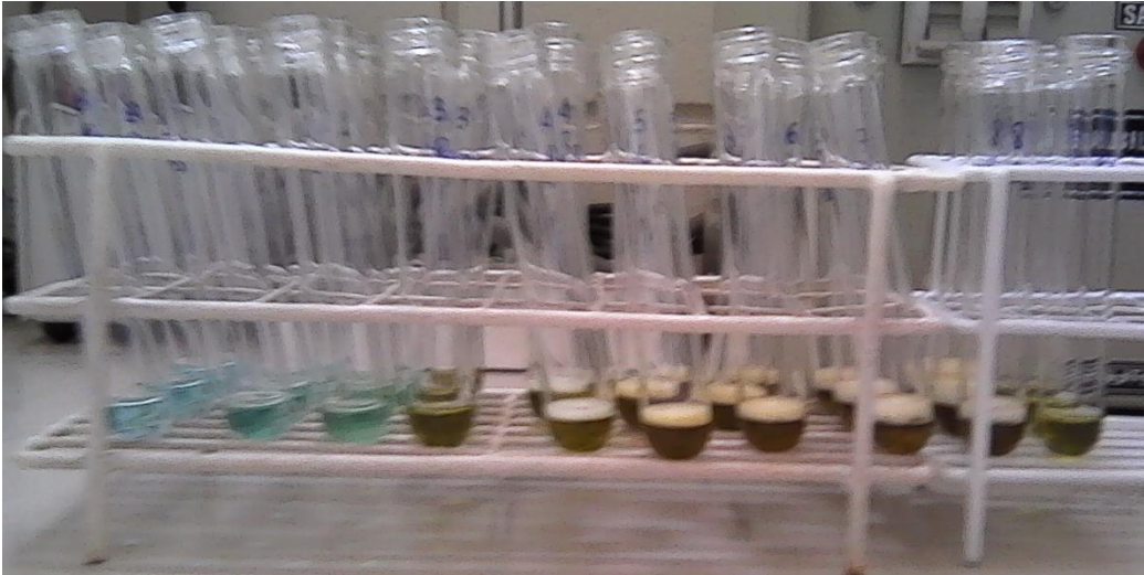
Fotografía 3. Medición de azúcares totales mediante método fenol-ácido
