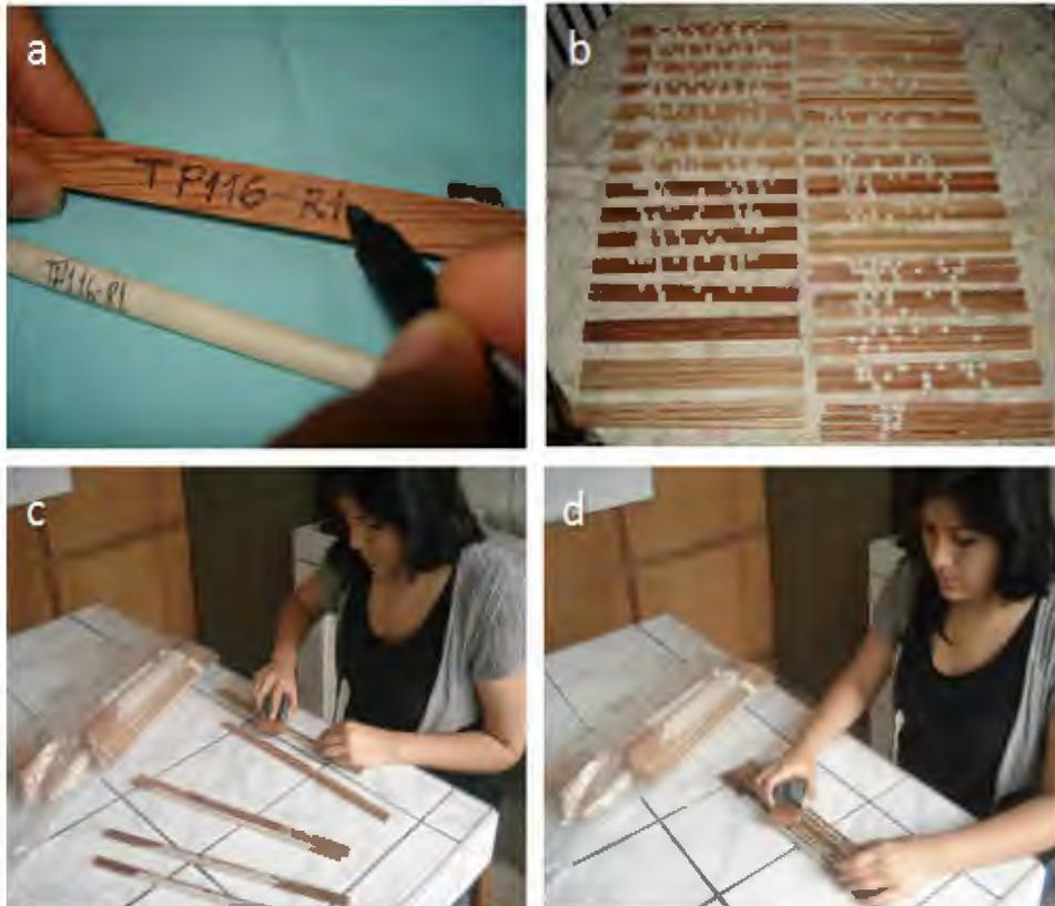
**Figura 9** a: Codificación de las muestras, b: Total de muestras montadas y codificadas, c y d: Lijado de las muestras
