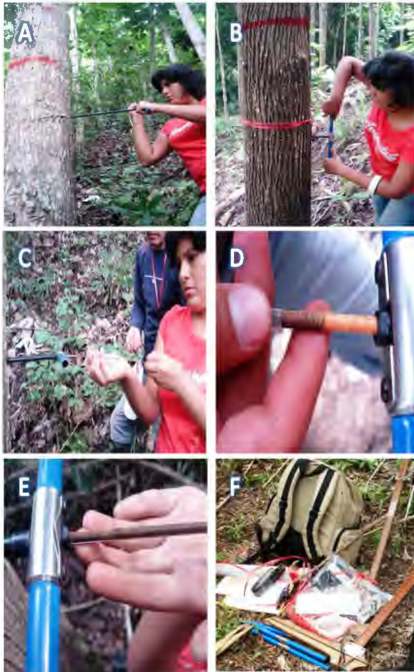
**Figura 6** a y b: Muestreo con sonda Pressler, c, d y e: Extracción de la muestra “Teca” y f: Equipos y materiales utilizados en campo
