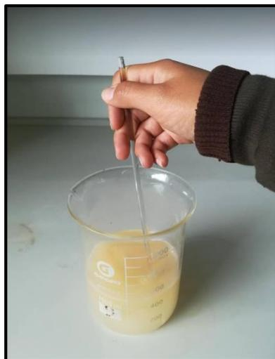
**Fotografía 10. Preparación de filtros de hierro: Adición de HCL.**
