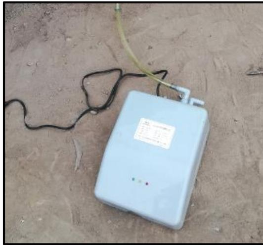
**Fotografía 8. Bomba para renovación de biogás en gasómetros.**
