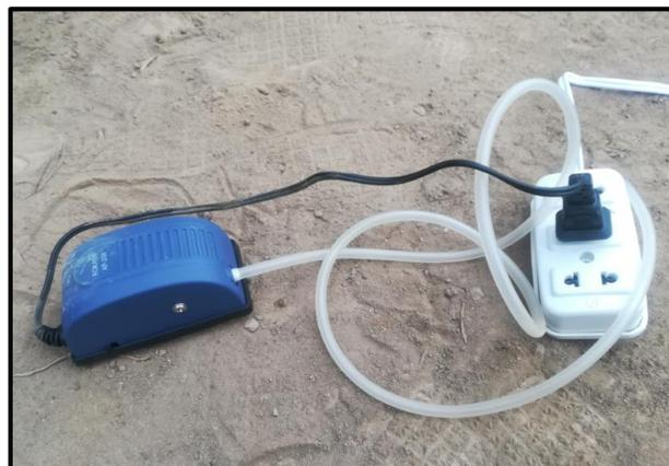
**Fotografía 7. Bomba utilizada para inyectar aire.**
