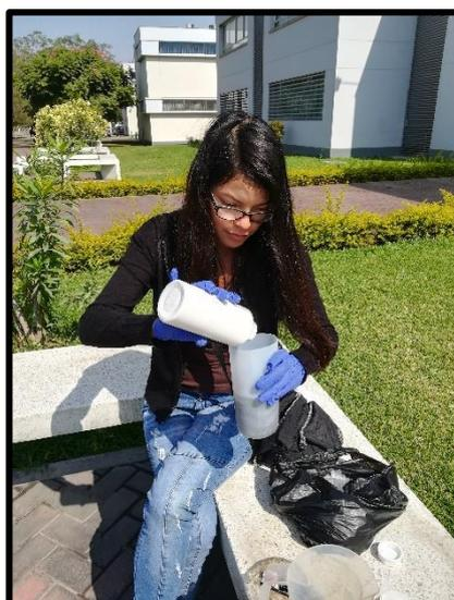
**Fotografía 13. Añadido de solución de HCl a las virutas y esponjas de hierro.**
