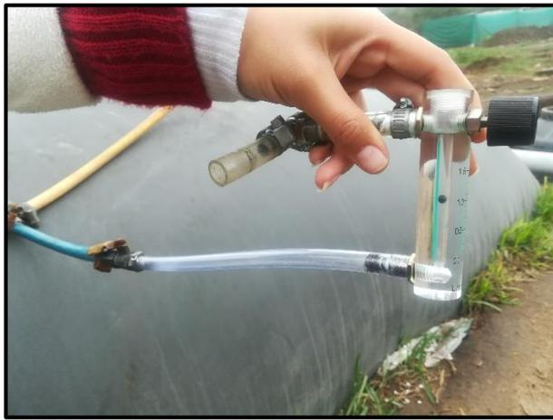
**Fotografía 21. Medición de flujo a la salida del biodigestor**
