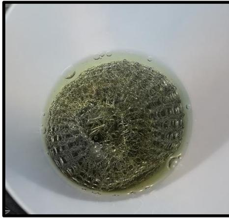
**Fotografía 11. Sumergido de las esponjas de hierro en soluciones de HCl.**
